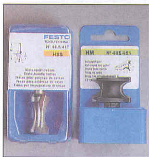
С помощью радиусных фрез можно формировать различные фигурные фаски, меняя ширину и глубину фрезерования и упорный подшипник на подшипник большего или меньшего размера.
