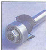
Хвостовики фрез могут быть разных диаметров, рассчитанных на обычные цанговые патроны. Самый ходовой размер — 8 мм.
